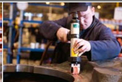
Dichten des Flansches am Hinterachs-Differential mit Loctite® 518
