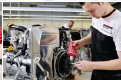
Schraubensicherung Loctite® 270: Hohe Festigkeit für extreme Belastungen
