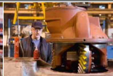
Differential zur Montage bereit
