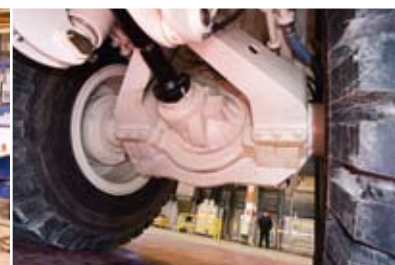
Das eingebaute Getriebe bei einem 100-t-Truck
