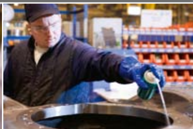
Reinigung des Flansches am Hinterachs-Differential mit Loctite® 7063
