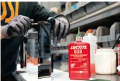
Montage von Armaturen für Handwaschbecken mit Loctite® 638
