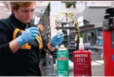
Einsatz von Loctite® 2701 auf passiven Metalloberflächen
