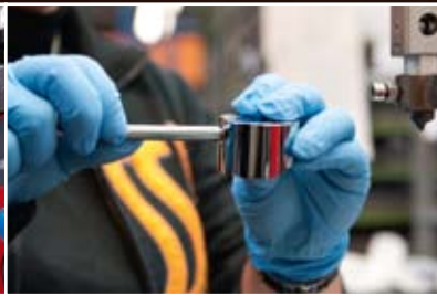
Montage von plattierten Teilen mit Loctite® 2701
