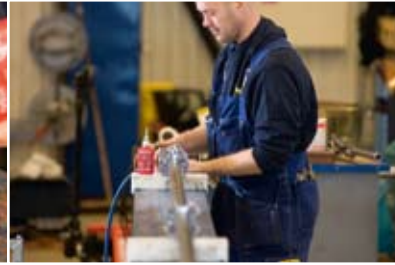
Montage der Rohre – Sicherung mit Loctite® 243
