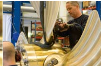
Nach nur 1 h muss die Verbindung einem Öldruck von 70 bar standhalten
