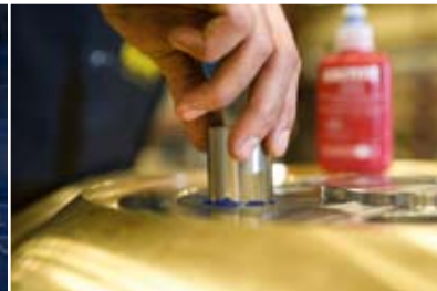
Ein Paßstift positioniert die Propellerschaukeln. Mit Loctite® 243 gesichert
