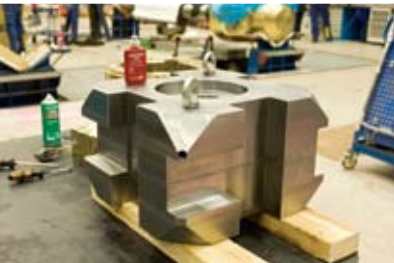
Loctite® 243 sichert den Propeller-Verstellmechanismus
