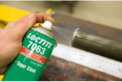
Reinigen der Hydraulikrohre mit Loctite® 7063
