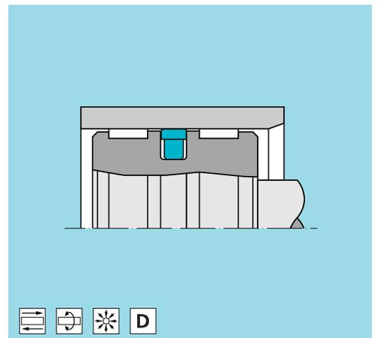
Anwendung: hin- und hergehend = rotierend = oszillierend = schraubenförmig = statisch = einfachwirkend = **E** doppelwirkend = **D**
