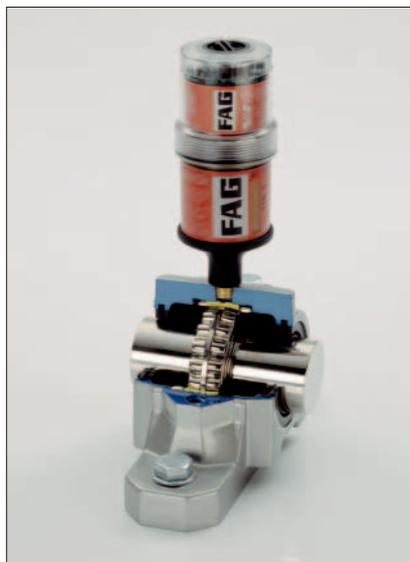
Der komplette Schmierstoffgeber, bestehend aus Antriebseinheit, LC-Einheit und Batteriesatz, wird über einen Stützadapter oder einen Schlauch an die Schmierstelle angeschlossen.
