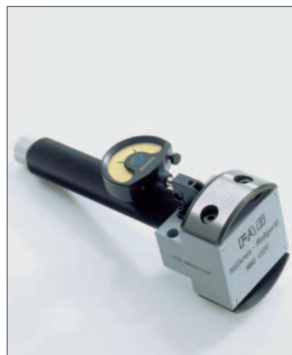
FAG Hüllkreismessgerät MGI 21 zum Einstellen der Radialluft bzw. der Vorspannung von Zylinderrollenlagern mit abziehbarem Innenring
