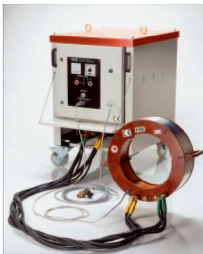
Erwärmungsanlage für Niederspannung mit Transformator zur Demontage von Zylinderrollenlager-Innenringen
