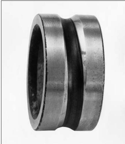
39: Schräg im Innenring liegende Laufspur am Rillenkugellager
