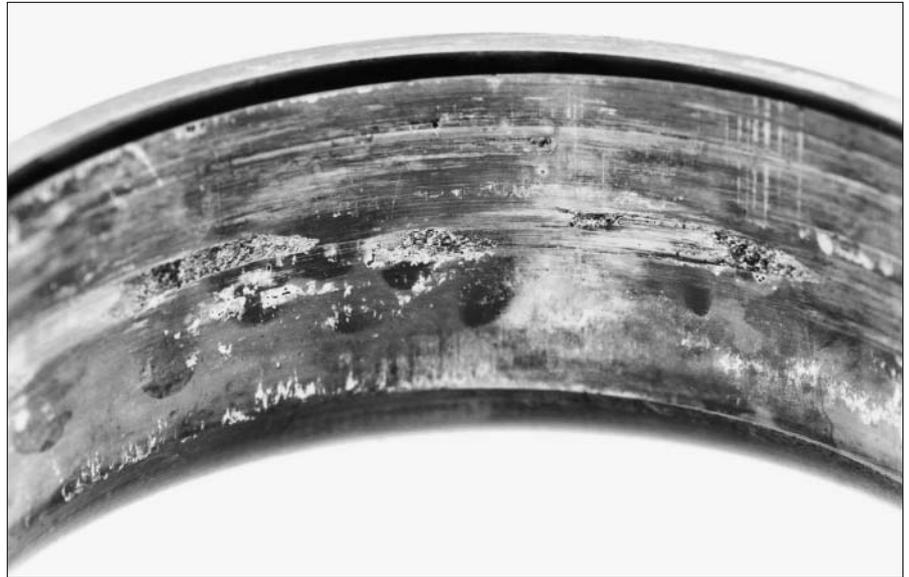
15: Freßspuren auf der Mantelfläche als Folge von Mitdrehen des Außenrings im Gehäuse
