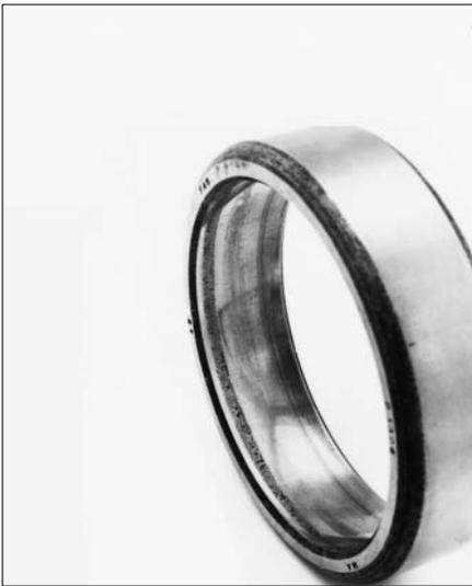
37: Ausbildung der Laufspuren bei einem axial verspannten, radial belasteten Pendelkugellager mit umlaufendem Innenring
