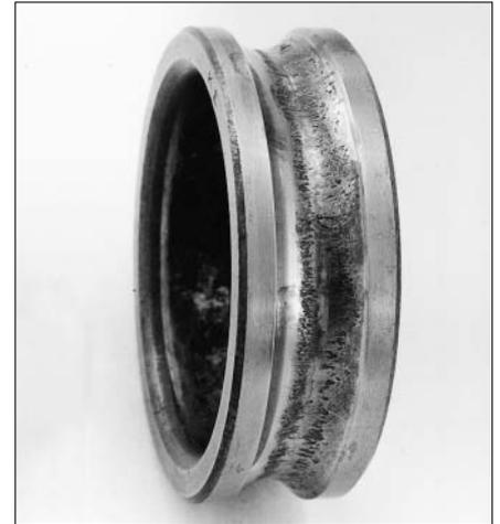
42: Fortgeschrittener Ermüdungsschaden am Rillenkugellager
