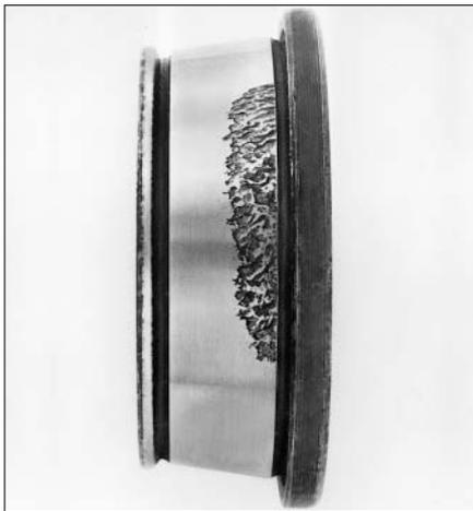
40: Verkippte Laufspur auf einem Kegelrollenlager
