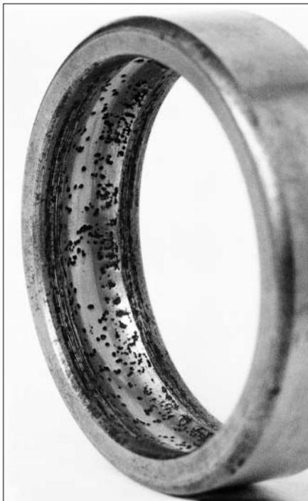
53: Rostbildung am Außenring eines Rillenkugellagers, dessen Korrosionsschutz durch Feuchtigkeit zerstört wurde
