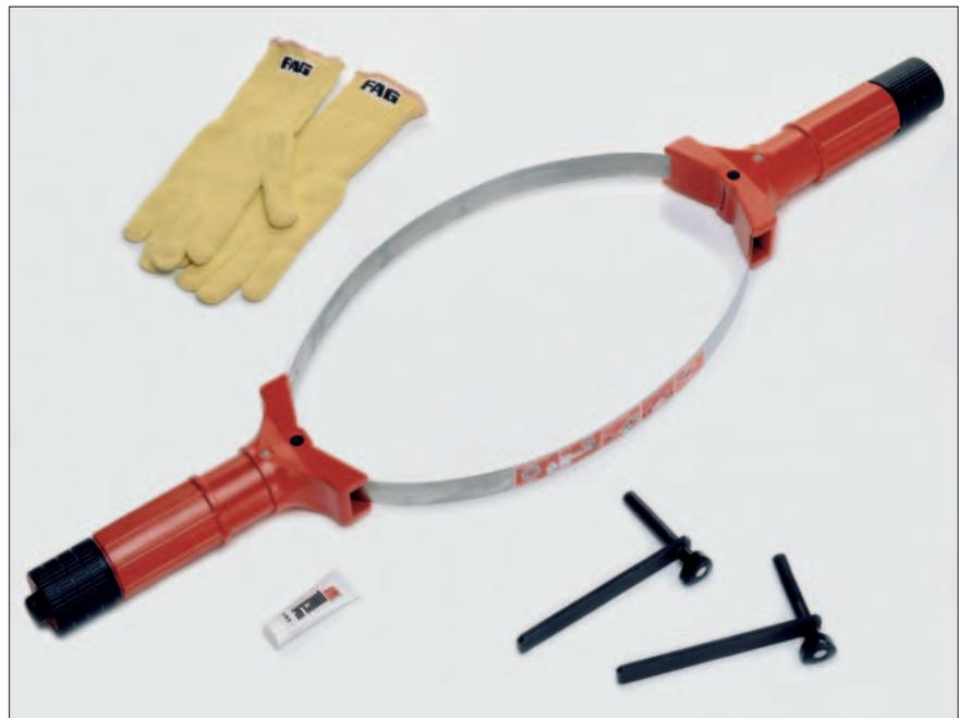
Für unterschiedliche Lageraußendurchmesser stehen drei Größen des Werkzeugs zur Verfügung.
