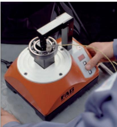
Induktives Anwärmgerät HEATER10
