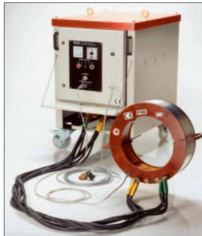
Erwärmungsanlage für Niederspannung mit Transformator zur Demontage von Zylinderrollenlager-Innenringen
