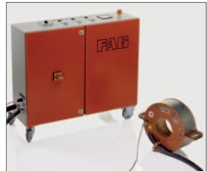
Schaltschrank für Erwärmungsanlage mit Netzspannung zur Demontage von Zylinderrollenlager-Innenringen
