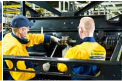
Die Schrauben am Hauptantrieb des Dreschers werden fest angezogen, das ergibt maximale Sicherheit
