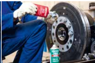
12 Bolzen werden mit Loctite® 243 gesichert
