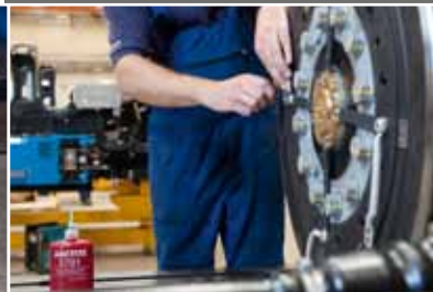
Sichern der Schrauben an der Erdungsleitung
