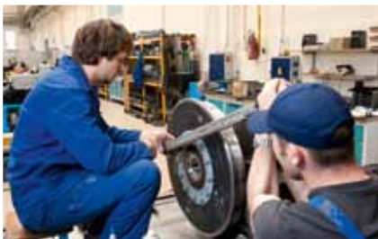
Die 12 radialen Schrauben werden festgezogen, um das Rad zuverlässig zu sichern
