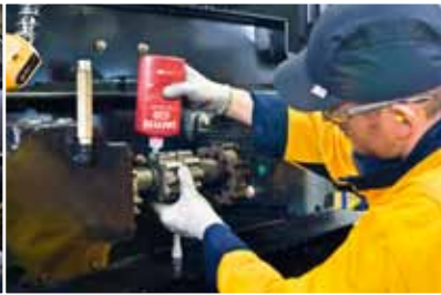
Loctite Fügeklebstoff® 638 kommt bei den Welle-Nabe-Verbindungen zum Einsatz
