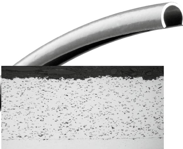
Abbildung 1: TriCom® ist eine Verbundbeschichtung, die aus einer Kobaltmatrix und einer Verstärkungsphase aus Chromkarbid besteht.
