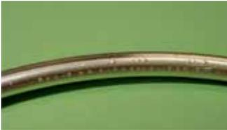
Abbildung 1: Blister (Blasen) auf einer Dichtung mit Standard-Silberbeschichtung nach 1000 Stunden Luftkontakt bei 260 °C (500 °F)
